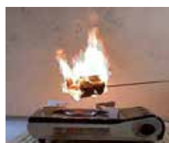
断熱材の燃焼実験
